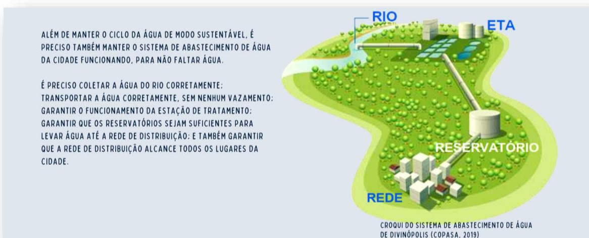
Figura 5. Sistema de Abastecimento de Água em Divinópolis, parte da página 7 da Bionarrativa Social (BIONAS) “Memórias do Rio Itaipocerica e os conflitos sobre a água em Divinópolis”, produzida neste trabalho.
